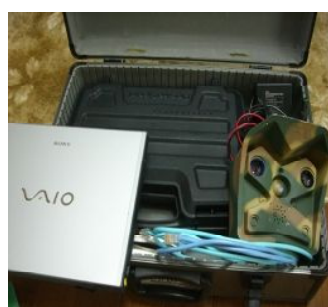
制御器とカメラ・ケーブル等一括トランクケースに収納 (パソコンは客先用意)
