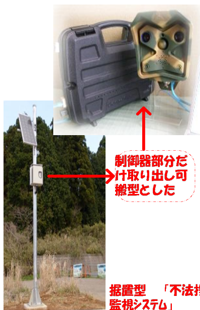
制御器とカメラ・ケーブル等一括トランクケースに収納 (パソコンは客先用意)
